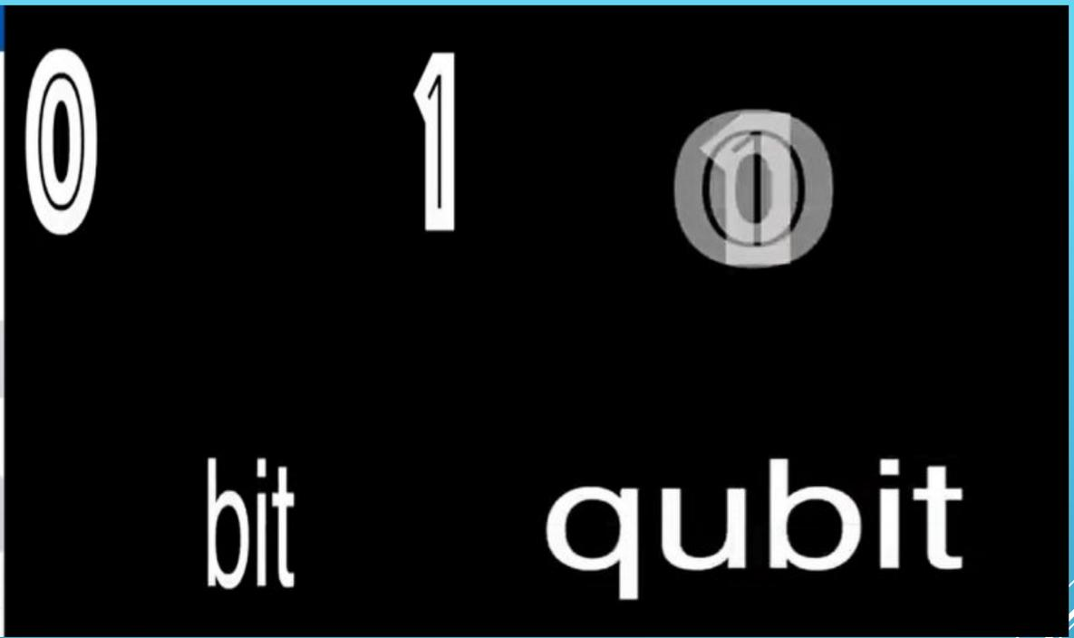
傳統計算機是通過集成電路中電路的通斷來實現0、1之間的區分，其基本單元為硅晶片一樣，量子計算機也有着自己的基本單位——昆比特（QUBIT）。昆比特又稱量子比特，它通過量子的兩態的量子力學體系來表示0或1。比如光子的兩個正交的偏振方向，磁場中電子的自旋方向，或核自旋的兩個方向，原子中量子處在的兩個不同能級，或任何量子系統的空間模式等。量子計算的原理就是將量子力學系統中量子態進行演化結果。
